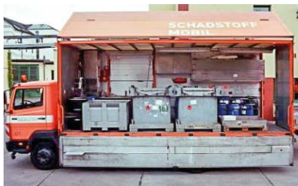
FIGURA 53 - CONFERIMENTO MOBILE PER RIFIUTI PERICOLOSI
