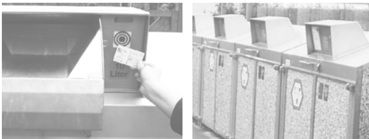
FIGURA 83 – CHAMBER SYSTEM AD ACCESSO ELETTRONICO
