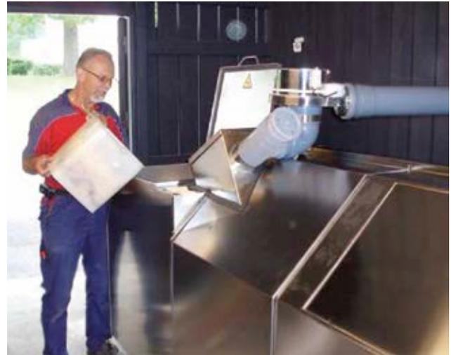
loco e coperto da teli semipermeabili (tipo Goretex) oppure essere successivamente trasferito in un qualsiasi impianto di compostaggio per completare la fase di maturazione e raffinazione finale. Se i compostatori elettromeccanici vengono utilizzati solo per la fase di maturazione accelerata il tempo medio di compostaggio all'interno delle compostiere è di 4-5 settimane.
